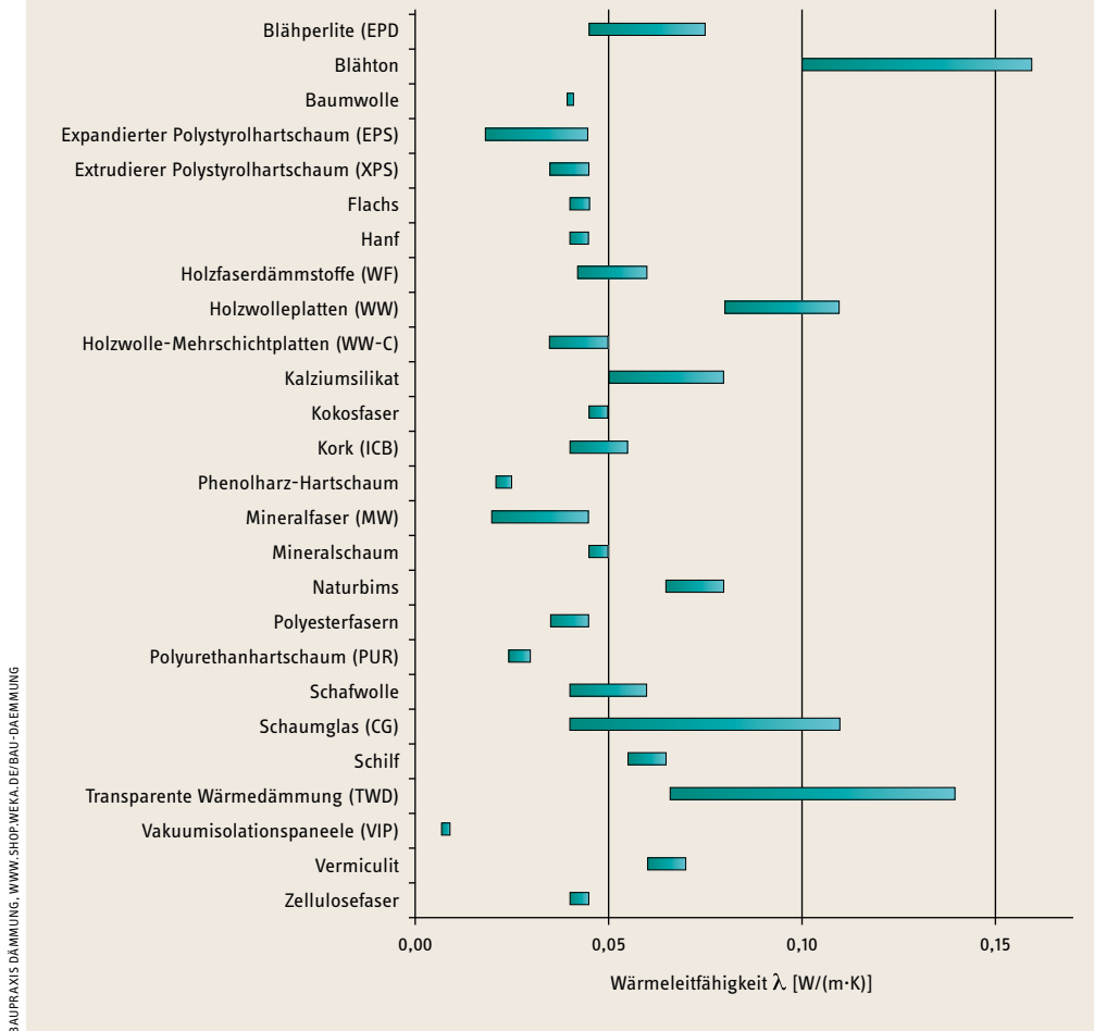
▲ Bereiche der Wärmeleitfähigkeit \lambda [W/(m·K)] von Wärmedämmstoffen
